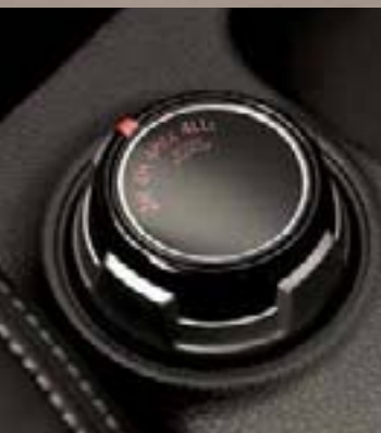
OTOČNÝ OVLADAČ REŽIMŮ POHONU 4X4
