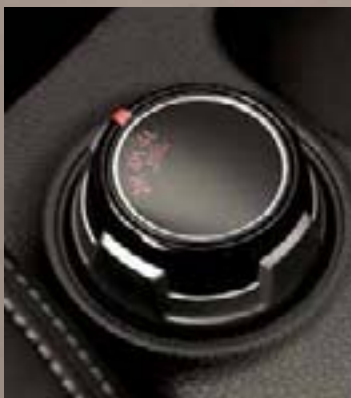
OTOČNÝ OVLADAČ REŽIMŮ POHONU 4X4
